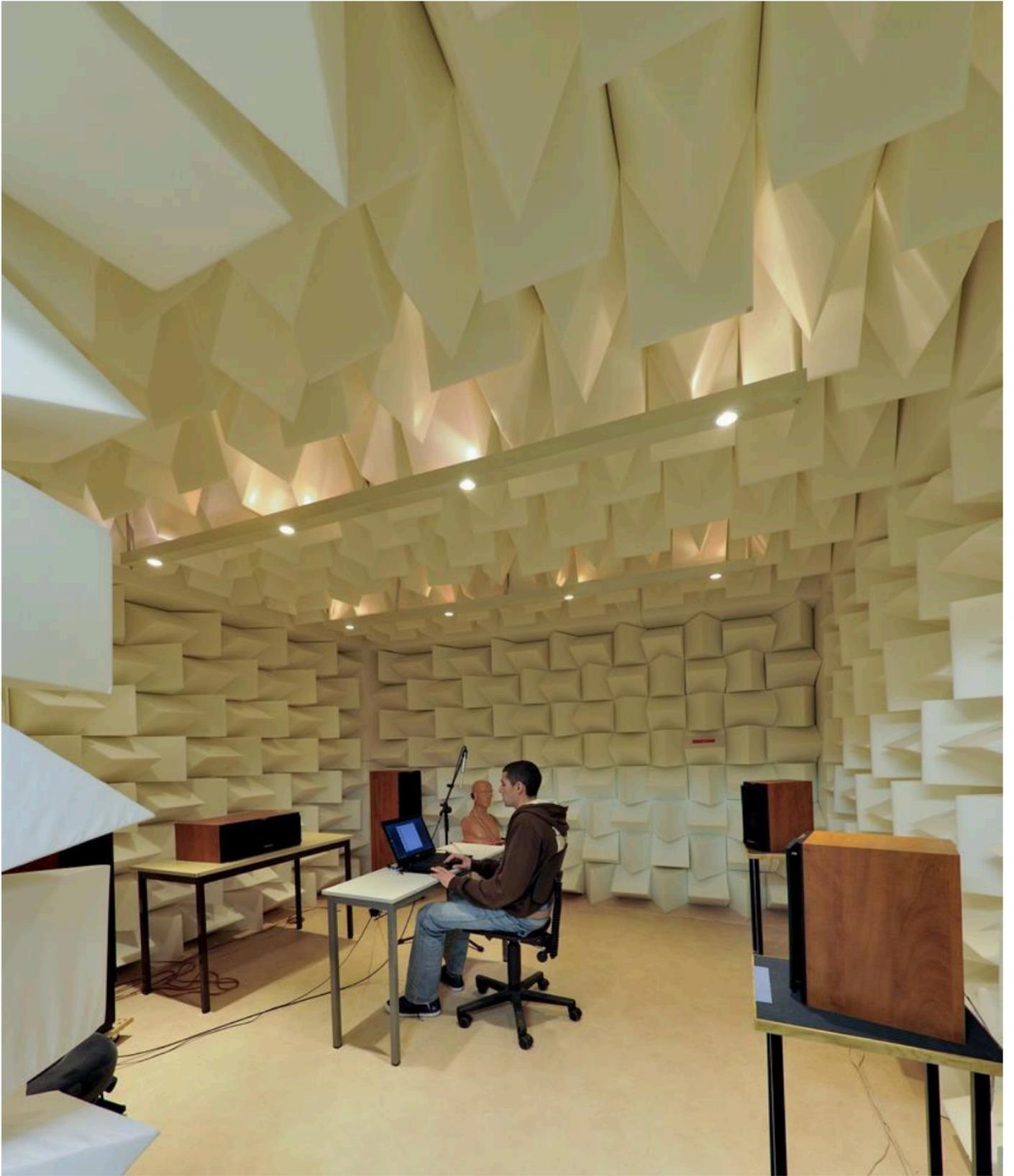
**Réalisation de tests perceptifs dans la salle anéchoïque du LMVA**
