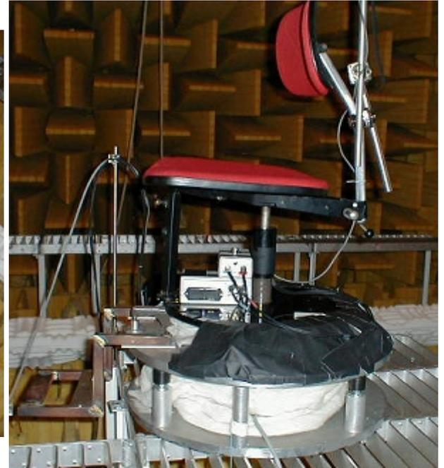
La chaise est réglable en hauteur et a une barre en acier pour le repose-pieds. Un support en aluminium était fixé dans le dossier du fauteuil, avec appui-tête, aidant les sujets à garder la tête droite devant eux; sa position est réglable en hauteur et en inclinaison. L'angle d'azimut est choisi par le logiciel de mesure, et le retour est envoyé par un capteur optique.
