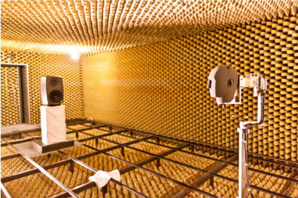
Fig. 60 Mise en place de la mesure dans la chambre anéchoïque de FH Köln.
