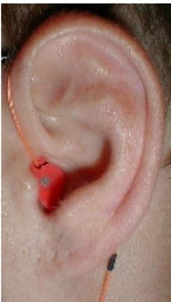
Nous effectuons des mesures HRIR dans des conditions de méat bloqué. La face avant de la capsule se trouvait à l'entrée du conduit auditif et, lorsque le méat est occlus, elle empêche la résonance du conduit auditif. La capsule a été insérée dans un mastic en silicone sur mesure, ce qui garantit que la capsule est maintenue fermement et que le microphone pourrait être placé dans la même position plus tard.
